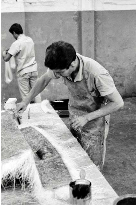
Das Fiberglas wird den Boxen entnommen. Hier begann die manuelle Produktion der Pumas.
