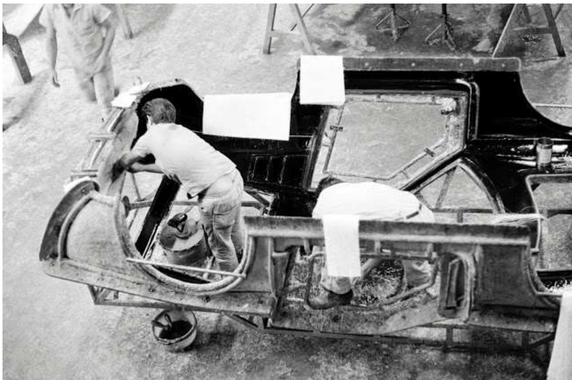
Das Fiberglas wird den Boxen entnommen. Hier begann die manuelle Produktion der Pumas.
